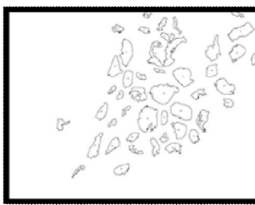
Gambar 1. Mikrograf karbon aktif tempurung ketapang, proses binerisasi dan segmentasi.
