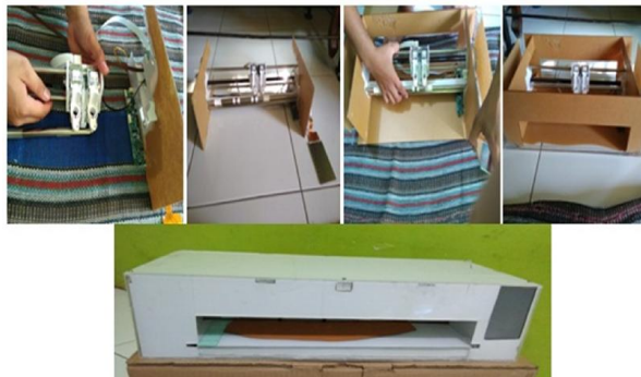
Gambar 7. Penyatuan rangka alat dengan komponen alat.
